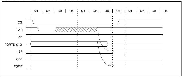
FIGURE 5-10: PARALLEL SLAVE PORT READ WAVEFORMS
