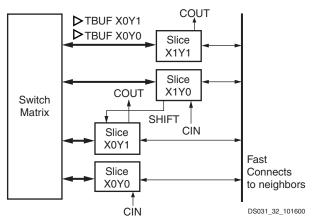
Figure 14: Virtex-II CLB Element
