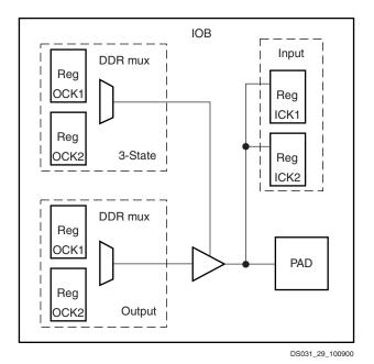
Figure 2: Virtex-II IOB Block
