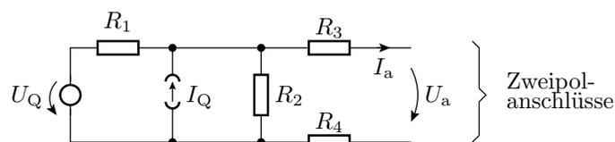
Bestimmen Sie den Kurzschlussstrom  $I_a (U_a = 0)$ , die Leerlaufspannung  $U_a (I_a = 0)$  am Ausgang und den Ersatzwiderstand  $R_{Ers} = -\frac{dU_a}{dI_a}$ . 3P
