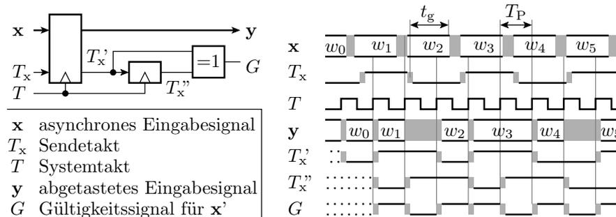
Der Empfänger muss Daten und Takt mit einer Taktperiode  $T_p < t_g$  abtasten, um jeden gültigen Wert mindestens einmal zu erfassen.
