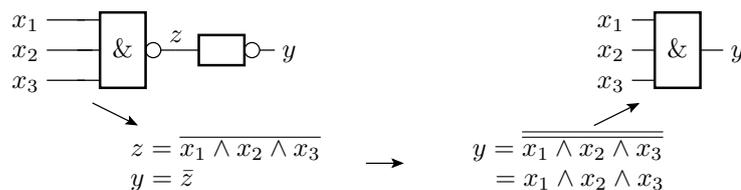
Doppelte Anwendung der Eliminationsgesetze:
