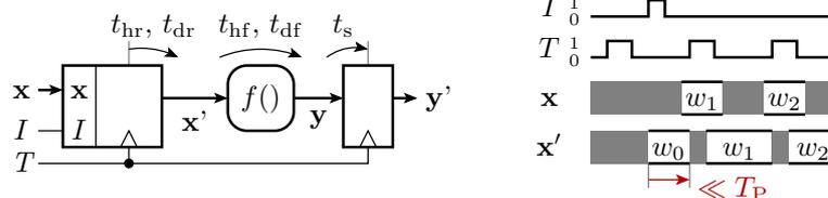
Selbst wenn das Eingaberegister seinen Anfangswert korrekt übernimmt, liegt der Initialwert am Registerausgang zu kurze Zeit stabil an, so dass das nachfolgende Register im ersten Schritt möglicherweise einen ungültigen Wert übernimmt.
