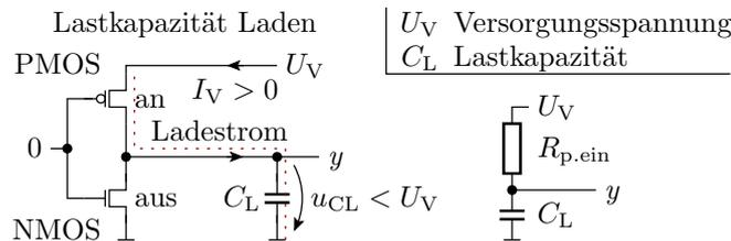
Energie zum Aufladen Lastkapazität (50% gespeichert, 50% Wärme):
