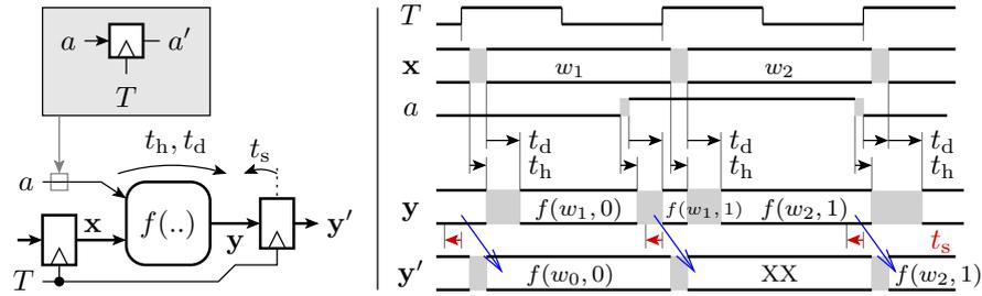
Das Signal  $y$  wird aus einem zum Takt ausgerichteten Signal  $x$  und einem nicht ausgerichteten Signal  $a$  gebildet. Änderungen von  $y$ , ausgelöst durch Änderungen von  $x$  sind zur nächsten aktiven Taktflanke immer gültig, aber von  $a$  ausgelöste Änderungen nicht. Wenn  $y$  ein Bitvektor ist, wird bei Abtastung außerhalb des Gültigkeitsfensters ein nicht vorhersehbarer Bitvektor aus Nullen und Einsen übernommen. Wirkung laufzeitabhängig.
