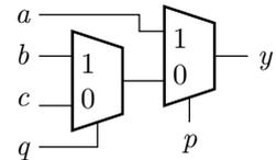
Statt Else-Zweig, ist auch ein bedingtes Überschreiben möglich. Wichtig ist nur, dass jedem Ausgabesignal im Berechnungsfluss ein neuer Wert zugewiesen wird. Denn das Speichern eines Wertes wird durch ein Latch nachgebildet.
