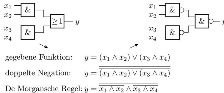
Eine ähnliche Vereinfachung ist auch mit OR-AND-Schaltungen möglich, die durch NOR-NOR-Schaltungen ersetzt werden können.
