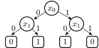
Als Programm, z.B. für die Simulation, besteht ein binäres Entscheidungsdiagramm aus verschachtelten If-Else-Anweisungen.
