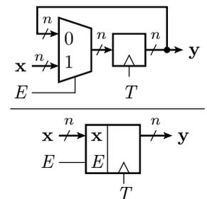
Eine bedingte Übernahme wird mit einem Multiplexer nachgebildet. Bei erfüllter Übernahmebedingung, im Beispiel  $E = '1'$ , Weiterleitung des Eingabewerts und sonst des Istwerts zum Registeringang.
