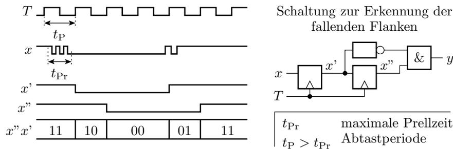
( $x'$ ,  $x''$  – einmal bzw. zweimal abgetastets Signal). Ohne die erste Abtastung ist  $x'$  und damit  $y$  nicht am Takt ausgerichtet und die nachfolgende Schaltung keine laufzeittolerante Register-Transfer-Funktion.
