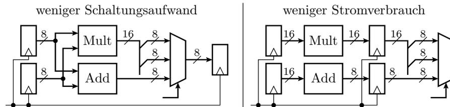
Für den Stromverbrauch wäre es günstiger, wenn nicht zu jeder benötigten Operation eine Parallelberechnung eines ungenutzten Ergebnisses erfolgt und nicht jedes Produkt zweimal gebildet werden muss, einmal für das niederwertige und einmal für das höherwertige Produktbyte. Das verlangt getrennte Operanden und Ergebnisregister für beide Rechenwerke, d.h. in Summe 56, statt 24 Registerbits.
