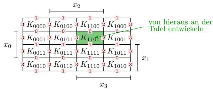
Anordnung der Eingabewerte so, dass sich die Konjunktionen benachbarter Felder genau in einer Negation unterscheiden, so dass benachbarte Nullen oder Einsen zu einer Konjunktion mit einer Variablen weniger zusammengefasst werden können.
