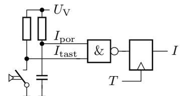
Bildung eines Gesamtinitialisierungssignals aus Power-On-Reset und Tasten-Reset und Ausrichtung an der aktiven Taktflanke.
