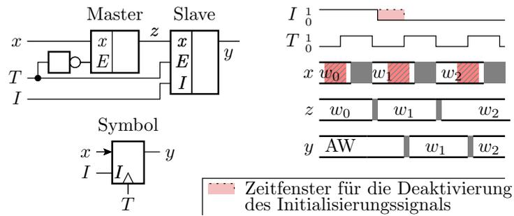
Sonst liegt der anschließend übernommene Wert zu kurz am Registerausgang an, so dass das Register hinter der nachfolgenden Verarbeitungsfunktion möglicherweise einen ungültigen Wert abtastet.
