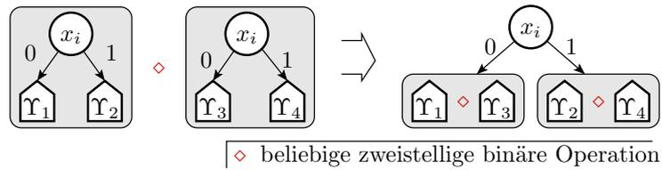
In einem ROBDD erfolgen auf allen Wegen die Entscheidungen in derselben Reihenfolge.
