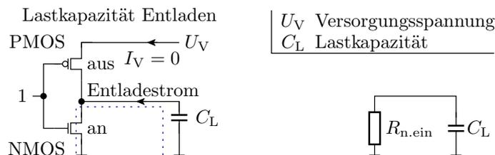
Beim Entladen der Lastkapazität wird die gespeicherte Energie in Wärme umgesetzt.
