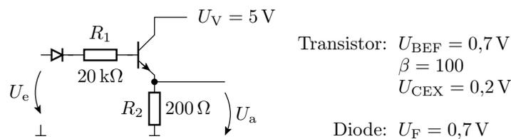
a) Zeichnen Sie die lineare Ersatzschaltung mit dem Transistor im Normalbereich. 1P
