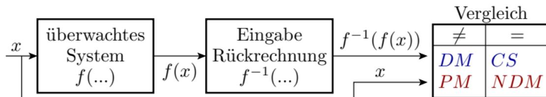
Da  $f(\dots)$  und  $f^{-1}(\dots)$  sich in Algorithmus und Fehlerwirkung unterscheiden, ist auch ohne zusätzliche konstruktive und organisatorische Maßnahmen ein höheres Maß an Verschiedenartigkeit der Wirkung von Fehlern und damit eine höhere *MC* zu erwarten.
