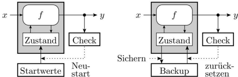
Bei einer Fehlfunktion werden oft interne Daten verfälscht. Zur Rückkehr in einen funktionsfähigen Zustand sind die internen Daten erneut mit zulässigen Werten zu initialisieren:
