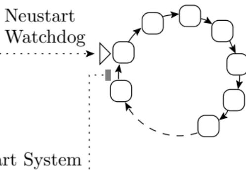
Das überwachte System setzt in periodisch zu erreichenden Sollzuständen einen Zeitzähler zurück, der bei Überlauf das System neu startet und dabei auch wieder einen zulässigen Zustand herstellt (Zeitüberwachung auf Lebenszeichen).
