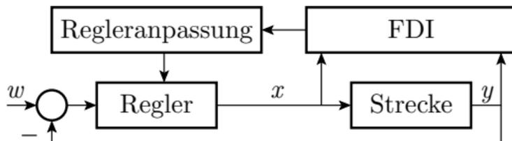
In einem Reglersystem wird vom Sollwert  $w$  der zu regelnde Ist-Wert  $y$  abgezogen. Aus der Differenz bildet der Regler den Stellwert  $x$  für die Regelstrecke (z.B. eine Heizung, wenn  $y$  eine Temperatur ist).
