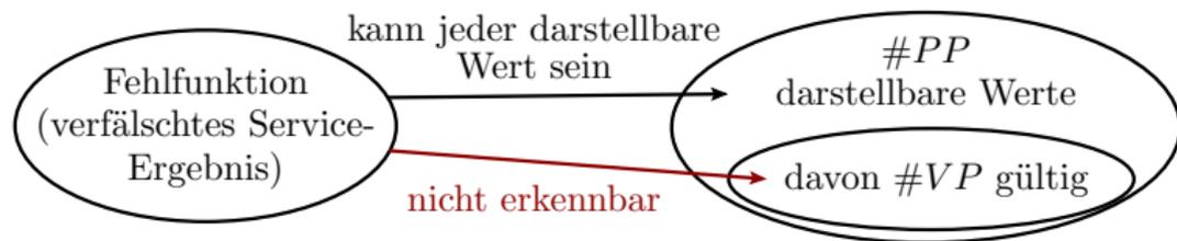
Die Fehlfunktionsabdeckung ist tendenziell um so höher, je geringer der Anteil der zulässigen Bitmuster ist. Wenn alle Verfälschungsmöglichkeiten gleichhäufig auftreten, alle unzulässige Muster als unzulässig und alle zulässigen Werte als zulässig erkannt werden:
