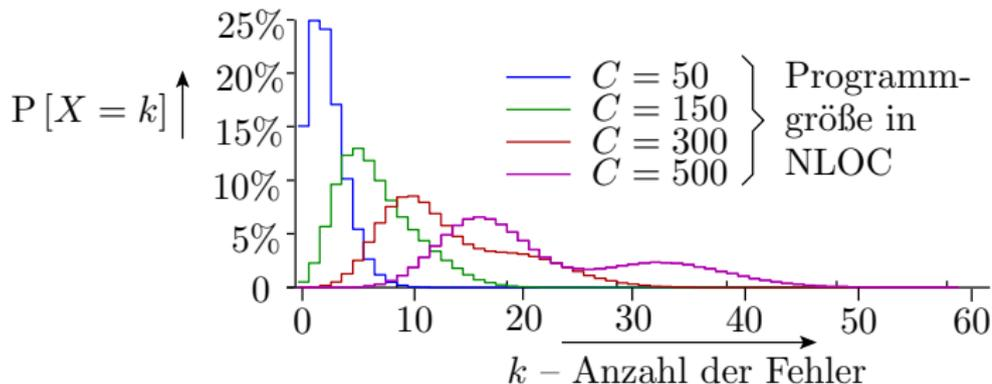
Die Polarisierung nimmt mit der Größe der Software-Bausteine, die vom Profi und vom Anfänger getrennt entwickelt werden, zu.
