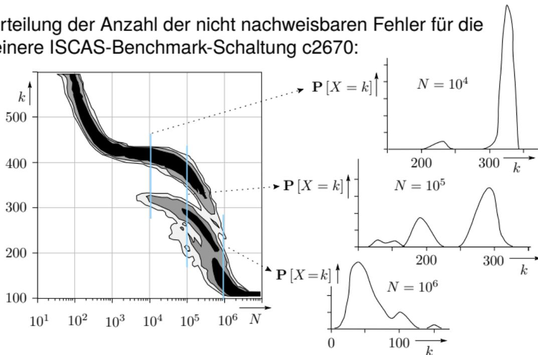
Im Bereich der Testsatzlänge  $N = 10^4$  bis  $10^6$  mehrere Gipfel.
