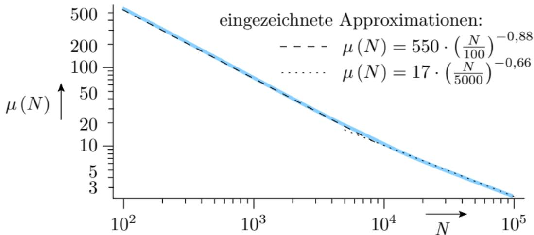
Formfaktor  $K = 0,88$  nähert den Bereich  $N \in [10^2, 10^4]$  und  $K = 0,66$  den Bereich bis  $N \in [10^4, 10^5]$  besser an. Aber Achtung, für  $N \geq 10^4$  sind die Zählwerte sehr klein und der Schätzfehler für den Erwartungswert  $\mu(N)$  und damit auch für den Formfaktor  $K$  groß.
