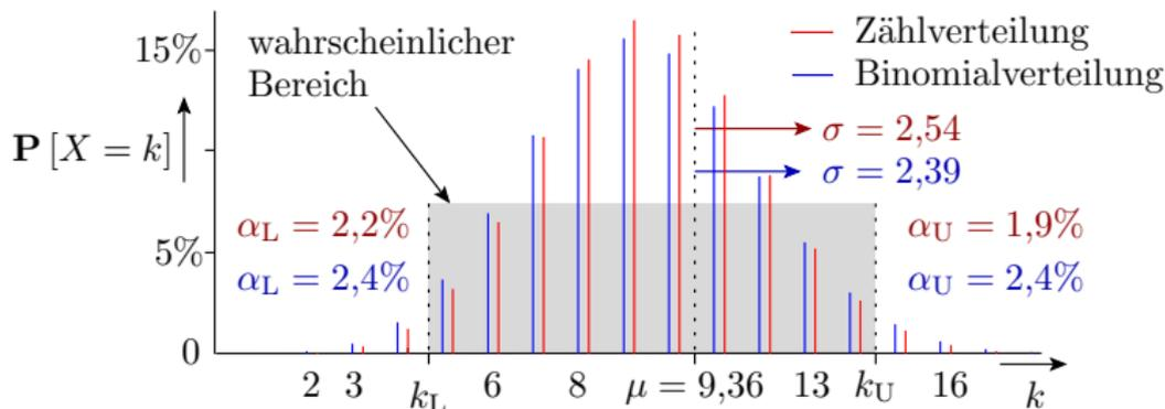
Bei gleicher Anzahl von unabhängigen Zählwerten  $n$  und  $p = \frac{1}{n} \cdot \sum_{i=1}^n p_i$  ist die Varianz der Binomialverteilung eine obere Schranke der Varianz einer Zählverteilung:
