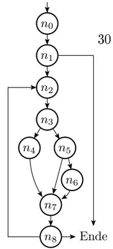
Der Kontrollflussgraph lässt sich automatisch aus dem Maschinenprogramm berechnen.
