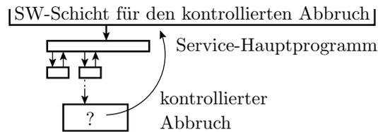
Fehlfunktionen durch Fehler oder Störungen der Hardware verlangen in der Regel kontrollierter Abbruch mit einer Reihe von Aktionen:
