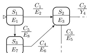
Beschreibung der Zielfunktion durch Mengen von Eingaben, Ausgaben, Zuständen und Zustandsübergänge mit Übergangsbedingungen. Die Zustände bzw. die Zustandsübergänge steuern Aktionen. Wie im CE-Modell werden bei Automaten für die Testauswahl die Ursachen (Bedingungen für Zustandsübergänge) und die Wirkungen (gesteuerte Aktionen) binarisiert.
