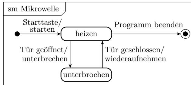
Ein Zustandsdiagramm (Verhaltenszustandsautomat, engl. behavioral state machine) beschreibt Funktionsabläufe durch:
