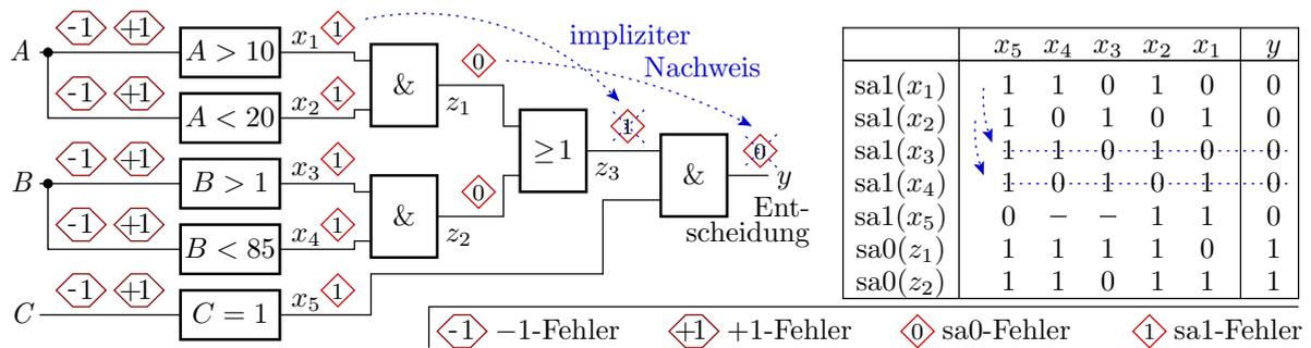
Instrumentierung Fehlernachweiskontrolle komplizierter als Zähler für Bedingungs Ausführung, z.B. Thread je angeregter Fehler bis Nachweis. Vorteile: man könnte Begriffe, Algorithmen und Erfahrungen von der Fehlersimulation für DIC übernehmen.
