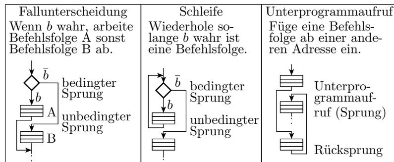
Nach jedem Befehl wird ein Folgebefehl abgearbeitet. Ausnahme Sprünge:
